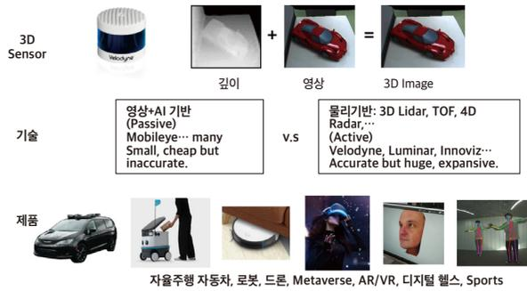
기반은 실리콘 기반의 영상센서와 렌즈가 작고 저렴해 졌다는 장점이 있고 여기에 사람의 뇌를 모방한 AI 인식 알고리즘이 접목되어 공간인식을 수행하는데 아직까지 완벽하지는 않다. 특별히 자율주행에서는 안전이 가장 중요한데, 실세계에 대한 AI 학습이 완벽하지 않은 경우 자율주행 사고 사례도 빈번히 보고되고 있다. 반면 액티브 레이저를 이용한 Lidar 기술은 직접 물리적인 수단을 통해 공간정보를 측정하는 것이므로 상대적으로 정확하고 안정적이다. 반면 레이저, 광학계 등이 필요하므로 크
