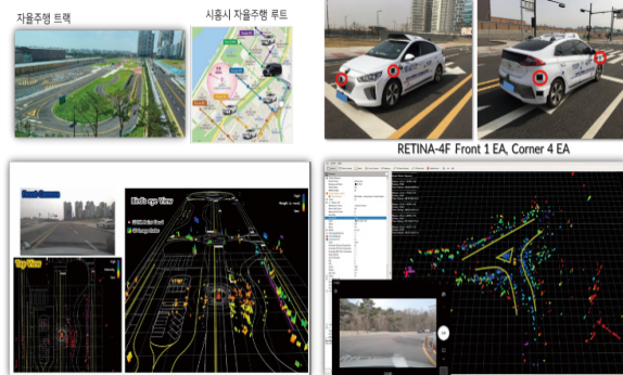
그림 3. SRS의 이미징 레이더 포인트 클라우드(RETIINA-4FN 5대 적용, 현대 아이오닉 자율주행 개조 차량)
