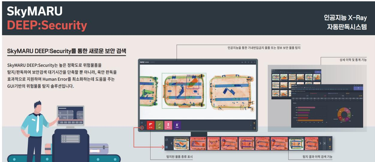
목이 포함되었는지를 확인하기 위해 보안검색대에서 수하물의 X-ray 검사가 필수적이다. X-ray 장비는 검사 영역에 조사한 X선을 사람이 볼 수 있는 가시광선의 영역으로 변환하여 디지털 영상으로 단순 송출하는 방식으로, 검사 영역 내에 들어온 검사 대상 물품에 대한 판독은 전적으로 X-ray 영상 판독이 가능한 전문 보안요원이 수행하는 영역으로 인식되었다. 여행 수요 증가에 따라 늘어나는 X-ray 검사 수요에 대해 기존의 전문 인력을 통한 수동 판독은 그 처리용량의 물리적인 한계와 효율의 문제가 있다. 공항에서는 수하물 판독의 효율성을 높이기 위해 딥파일을 이용하여 위해물품 이미지를 학습하였고 자동으로 위해물품을 검출(Detection)하는 AI 판독 보조 시스템을 개발하였다. 이 제품은 국내 5개의 공항과 국회, 다수의 민간기업 등에서 활용되고 있다.
