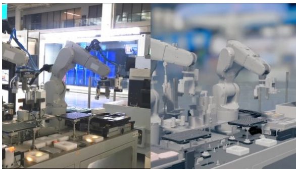
그림 5. 로보틱스시뮬레이션을 활용한 하이얼 공장자동화 시스템. 오른쪽이 유니티로 만들어진 시뮬레이션 화면
